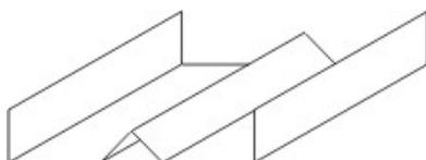
Соединитель панелей применяют для продольной стыковки потолочных панелей DW 80/20.
