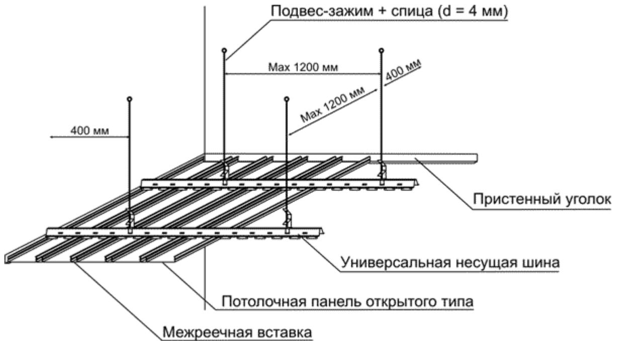
Схема монтажа подвесного реечного потолка Geipel® закрытого типа
